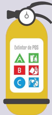
Extintor de PQS
